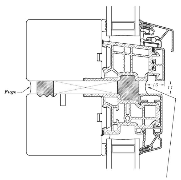
Udvendig fuge trækkes ca. 15 mm tilbage fra forkant, så drænhuller ikke fuges til.
