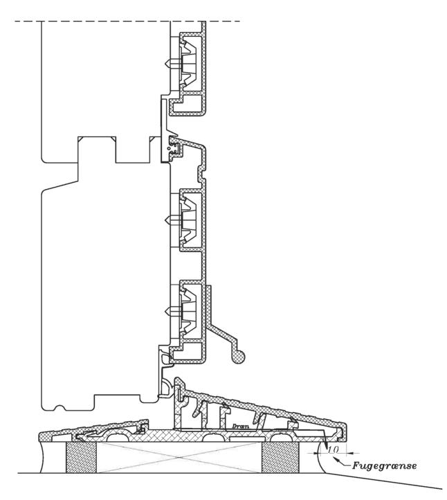
Udvendig fuge trækkes min. 10 mm tilbage fra forkant, så drænhuller ikke fuges til.
