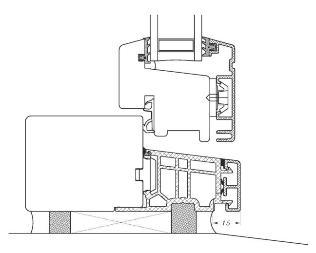
Udvendig fuge trækkes ca. 15 mm tilbage fra forkant, så drænhuller ikke fuges til.
